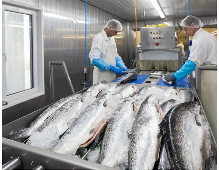
**Mehrfach pro Woche werden per LKW ganze Lachse aus Norwegen, Irland oder Schottland angeliefert. Das Abtrennen der Köpfe erfolgt manuell, weil dadurch eine bessere Ausbeute als Maschinen erreicht wird.**
